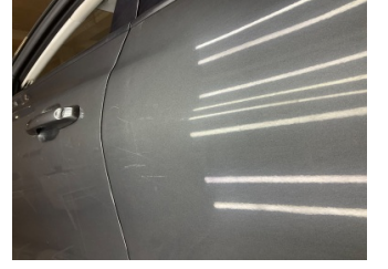
Kapı, sol arka, Kapı, sol arka > Küçük Vuruk
