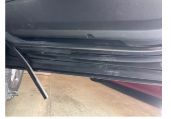
Kapı, sağ ön, Kapı fitili > Sabitlemesi Hatalı
