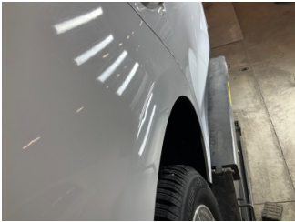
Çamurluk, sağ arka, Çamurluk, sağ arka > Ezik
