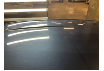
Tavan, Tavan > Dolu Hasarı
