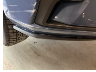
Tampon, ön, Spoiler > Sabitlemesi Hatalı
