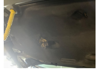
Motor kaputu, İzolasyon döşemesi > Hasarlı
