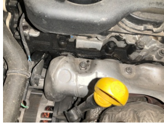
Motor, Motor > Yağ Kaçağı
