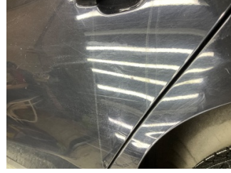
Kapı, sol arka, Kapı, sol arka > Çizik
