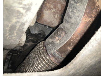
Motor, Motor > Yağ Kaçağı
