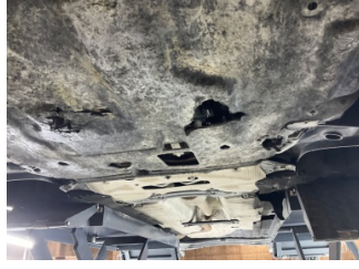
Motor, Alt muhafaza > Hasarlı
