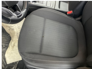
Döşemeler/Kapaklar, Döşemeler/Kapaklar > Yakıcı Madde ile Zarar Görmüş
