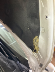
Motor, Kaput izolasyonu > Hasarlı
