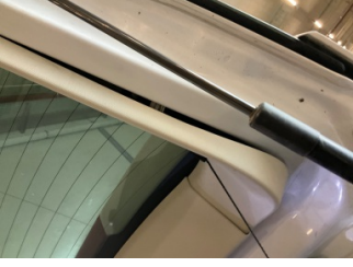
Döşemeler/Kapaklar, Bagaj kapağı, iç döşemesi > Sabitlemesi Hatalı
