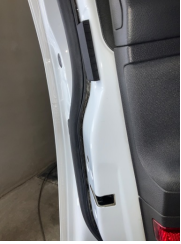
Kapı, sol ön, Kapı fitili > Sabitlemesi Hatalı
