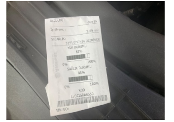
Elektrik donanımı/Pano, Akü > Test Sonucu
