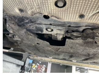
Motor, Alt muhafaza > Hasarlı
