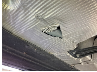
Kaporta, Muhafaza, orta > Hasarlı
