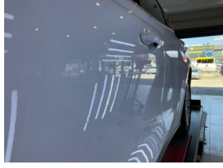
Kapı, sol ön, Kapı, sol ön > Ezik
