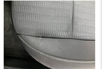
Döşemeler/Kapaklar, Döşemeler/Kapaklar > Yakıcı Madde Ile Zarar Görmüş
