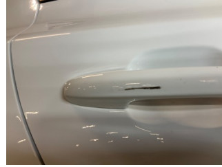
Kapı, sağ arka, Kapı kolu, dış > Çizik
