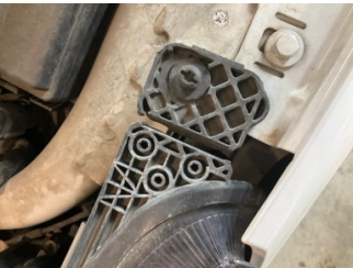
Farlar, Far bağlantı ayağı, sol > Hasarlı
