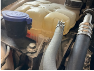
Motorsoğutması, Soğutma sıvısı > Eksik
