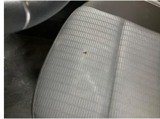
Döşemeler/Kapaklar, Döşemeler/Kapaklar > Yakıcı Madde Ile Zarar Görmüş
