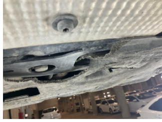
Motor, Alt muhafaza > Hasarlı
