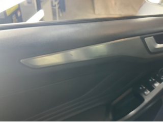
Döşemeler/Kapaklar, Döşemeler/Kapaklar > Deforme Olmuş
