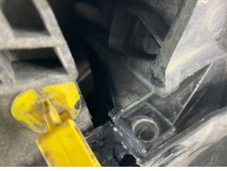
Farlar, Far bağlantı ayağı, sol > Standart Dışı Onarım
