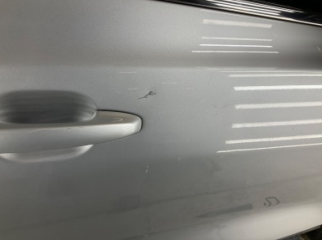
Kapı, sağ ön, Kapı, sağ ön > Çizik
