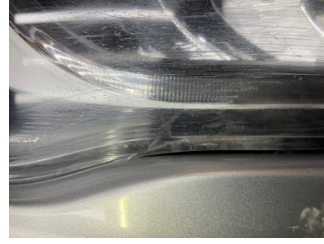
Farlar, Far camı, sağ > Çatlak
