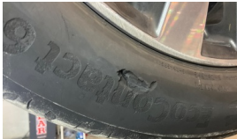
Lastik, sağ ön > Hasarlı
