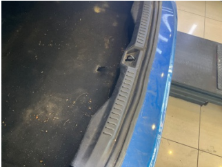
Döşemeler/Kapaklar, Döşemeler/Kapaklar > Çizik
