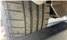
Tekerlek seti > Deforme Olmuş
