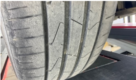
Tekerlek seti > Deforme Olmuş
