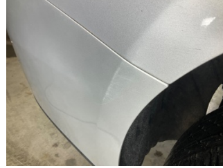
Tampon, arka, Arka tampon > Yüzeysel Çizik
