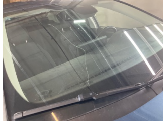
Camlar, Ön cam > Hasarlı
