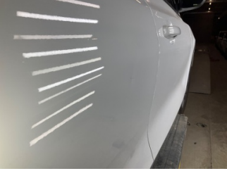
Kapı, sağ arka, Kapı, sağ arka > Ezik
