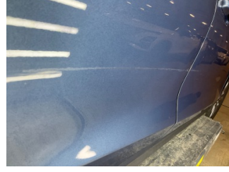
Kapı, sağ arka, Kapı, sağ arka > Ezik
