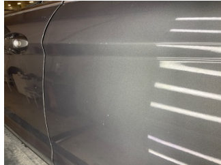
Kapı, sol arka, Kapı, sol arka > Çizik
