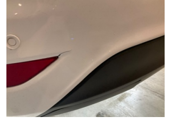
Tampon, arka, Arka tampon > Boyası Atmış
