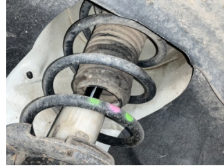
Ön aks, Amortisör körüğü, sağ > Hasarlı
