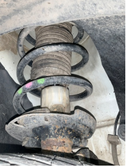
Ön aks, Amortisör körüğü, sol > Hasarlı
