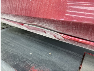
Marşbiyel, sol, Marşbiyel, sol > Hasarlı
