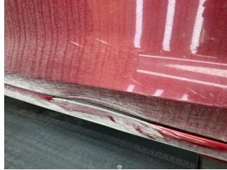
Kapı, sol ön, Kapı, sol ön > Hasarlı
