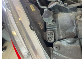
Farlar, Far bağlantı ayağı, sağ > Standart Dışı Onarım
