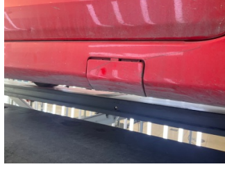
Marşbiyel, sağ, Marşbiyel plastiği, sağ > Sabitlemesi Hatalı
