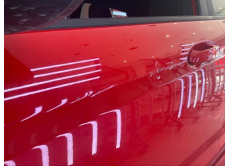
Kapı, sol ön, Kapı, sol ön > Hasarlı
