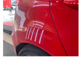
Çamurluk, sağ arka, Çamurluk, sağ arka > Taş Izi
