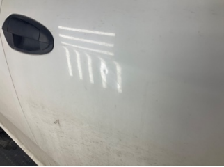
Kapı, sağ ön, Kapı, sağ > Noktasal Ezik
