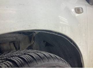
Çamurluk, sağ, Davlumbaz > Sabitlemesi Hatalı
