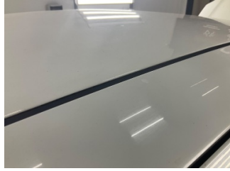
Kaporta, Sağ Üst Frangart > Boyası Atmış
