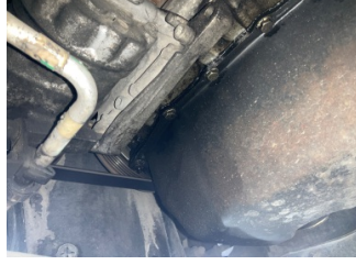
Motor, Motor > Yağ Kaçağı
