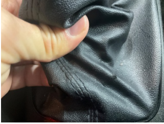
Şanzıman, Vites körüğü > Hasarlı
