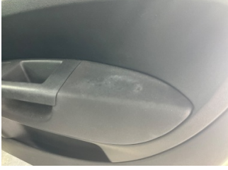
Döşemeler/Kapaklar, Döşemeler/Kapaklar > Kirlenmiş
