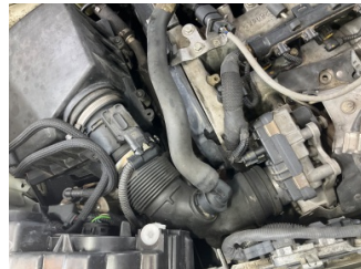
Motor, Hava filtresi kabı > Sabitlemesi Hatalı
