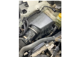
Motor, Hava filtresi kabı > Kırılmış
