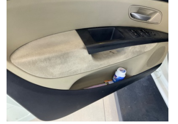
Döşemeler/Kapaklar, Döşemeler/Kapaklar > Deforme Olmuş
