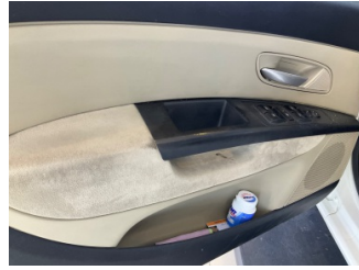
Döşemeler/Kapaklar, Döşemeler/Kapaklar > Yakıcı Madde ile Zarar Görmüş
