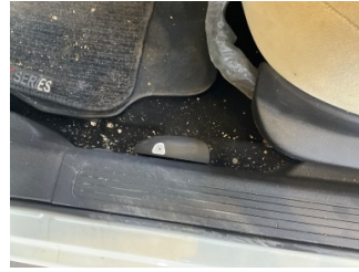
Döşemeler/Kapaklar, Döşemeler/Kapaklar > Yakıcı Madde ile Zarar Görmüş
