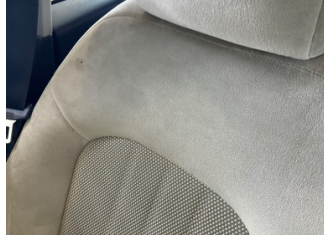
Döşemeler/Kapaklar, Döşemeler/Kapaklar > Yakıcı Madde Ile Zarar Görmüş
