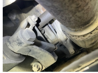
Ön aks, Aks mili, sağ > Yağ Kaçağı
