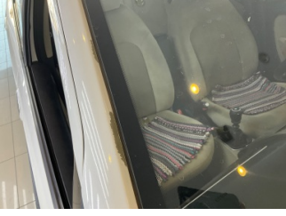
Tavan, Ön cam direği, sağ > Boyası Atmış
