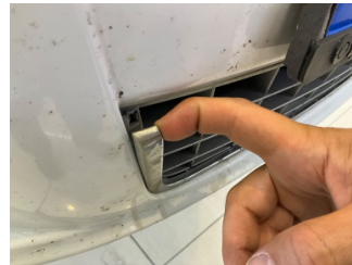
Tampon, ön, Ön tampon ızgarası > Hasarlı
