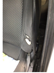
Koltuklar, ön, Koltuk, sol ön > Deforme Olmuş
