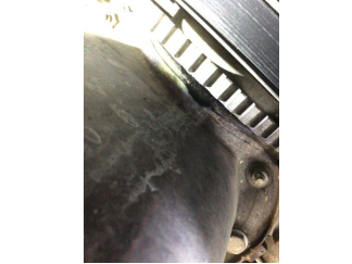
Motor, Yağ karteri contası > Yağ Kaçağı
