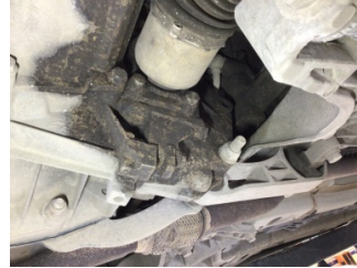
Ön aks, Aks mili, sol > Yağ Kaçağı
