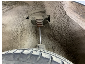
Arka aks, Amortisör körüğü, sol > Hasarlı
