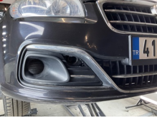
Tampon, ön, Çeki demir kapağı > Sökülmüş-Yok
