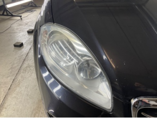
Farlar, Far camı, sağ > Deforme Olmuş
