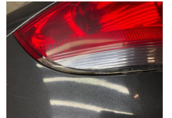
Arka lambalar, Arka lamba camı, sol > Çatlak
