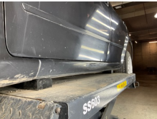
Marşbiyel, sol, Marşbiyel, sol > Hasarlı
