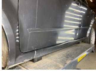
Kapı, sol ön, Kapı, sol ön > Ezik
