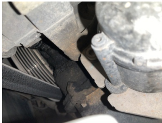
Motor, Motor > Yağ Kaçağı
