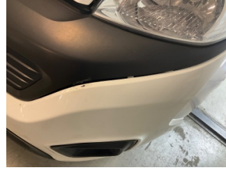
Tampon, ön, Ön tampon > Sabitlemesi Hatalı
