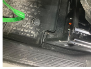
Taban, Taban halısı > Yakıcı Madde ile Zarar Görmüş
