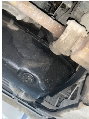
Motor, Motor > Yağ Kaçığı
