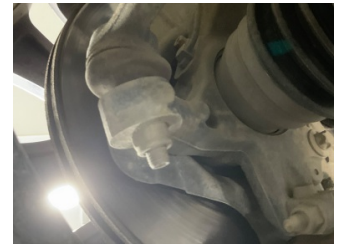
Ön aks, Denge çubuğu, bağlantı cubuğu sol > Deforme Olmuş
