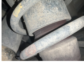
Arka aks, Amortisör körüğü, sol > Deforme Olmuş
