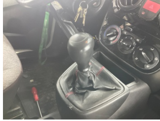
Şanzıman, Vites topuzu > Deforme Olmuş
