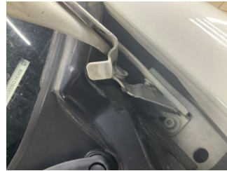
Motor kaputu, Dayama çubuğu/Amortisör > Hasarlı
