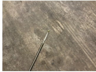
Motor, Yağ seviyesi > Eksik
