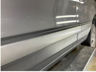
Kapı, sol ön, Kapı bandı > Çizik
