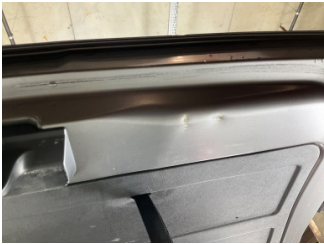
Bagaj kapağı/kapısı, Bagaj kapısı > Vuruk
