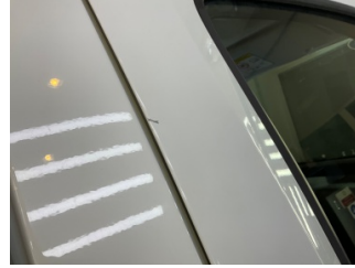
Kapı, sağ ön, Kapı, sağ ön > Çizik
