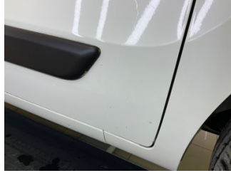
Kapı, sağ ön, Kapı, sağ ön > Çizik
