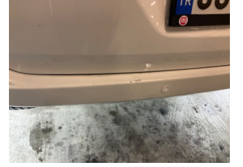
Tampon, arka, Arka tampon > Çatlak
