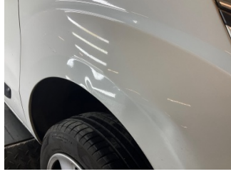
Çamurluk, sağ, Çamurluk, sağ > Hasarlı
