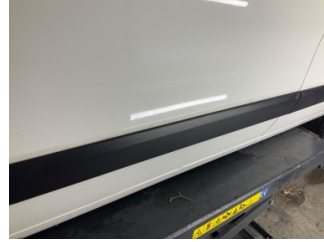
Kapı, sol ön, Kapı bandı > Çizik
