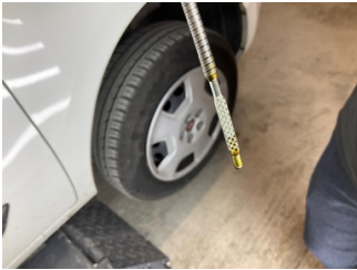
Motor, Yağ seviyesi > Eksik
