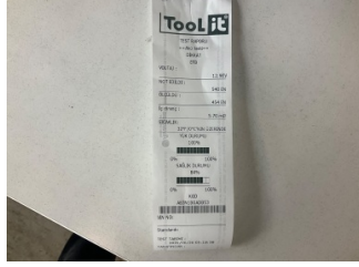
Elektrik donanımı/Pano, Akü > Test Sonucu
