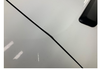
Kapı, sol ön, Kapı, sol ön > Boyası Atmış
