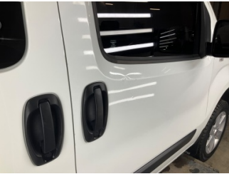
Kapı, sağ ön, Kapı, sağ ön > Vuruk
