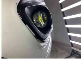
Sis lambaları, Sis Izgarası Sağ > Sabitlemesi Hatalı
