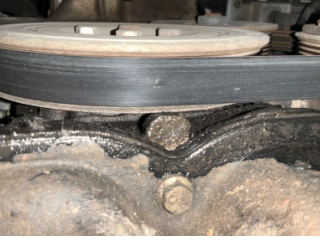
Motorsoğutması, Kayış > Çatlak
