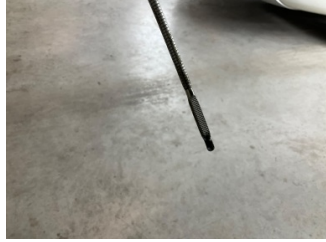
Motor, Yağ seviyesi > Eksik
