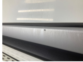
Kapı, sol ön, Kapı, sol > Taş İzi
