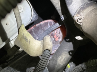
Motorsoğutması, Soğutma sıvısı > Sızdırıyor
