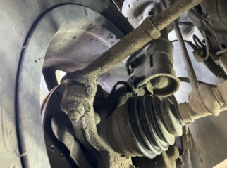
Direksiyon sistemi, Rot kolu/Rot başı, sol > Hasarlı
