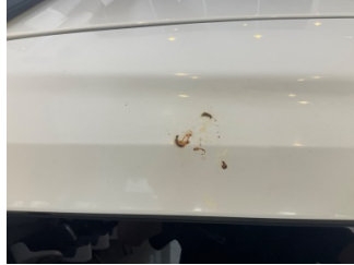
Bagaj kapağı/kapısı, Bagaj kapısı > Yakıcı Madde ile Zarar Görmüş
