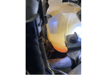
Motorsoğutması, Soğutma sıvısı > Eksik
