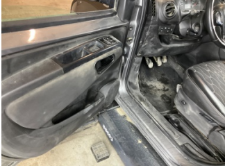
Döşemeler/Kapaklar, Döşemeler/Kapaklar > Deforme Olmuş
