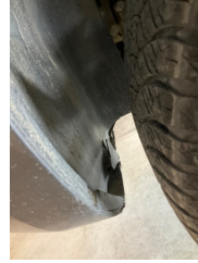
Çamurluk, sol, Davlumbaz > Hasarlı
