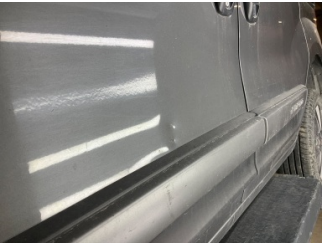
Kapı, sol ön, Kapı, sol ön > Ezik
