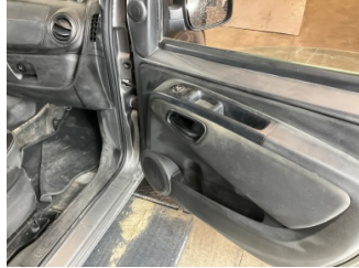
Döşemeler/Kapaklar, Döşemeler/Kapaklar > Deforme Olmuş
