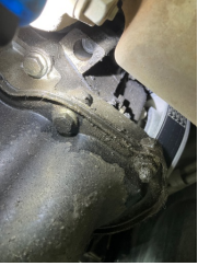
Motor, Motor > Yağ Kaçağı
