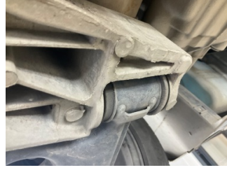
Ön aks, Alt Travers > Deforme Olmuş
