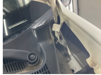
Motor kaputu, Dayama çubuğu/Amortisör > Hasarlı
