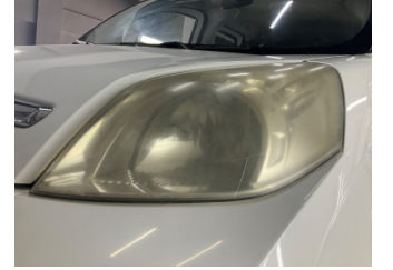
Farlar, Far camı, sol > Deforme Olmuş
