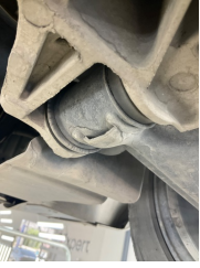
Ön aks, Alt Travers > Deforme Olmuş
