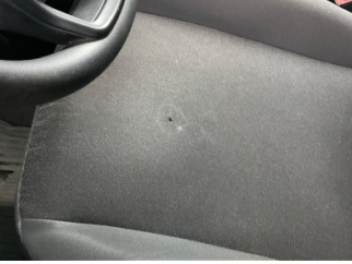
Döşemeler/Kapaklar, Döşemeler/Kapaklar > Yakıcı Madde ile Zarar Görmüş
