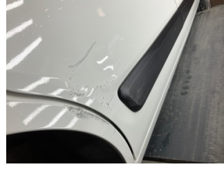
Kapı, sağ arka, Kapı, sağ arka > Ezik
