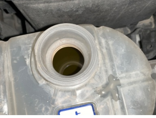
Motorsoğutması, Soğutma sıvısı > Kirlenmiş
