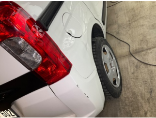
Çamurluk, sağ arka, Çamurluk, sağ arka > Ezik
