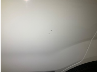
Kapı, sol arka, Kapı, sol arka > Çizik
