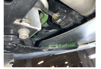
Kalorifer/Klima, Kalorifer/Klima > Sızdırıyor
