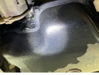
Motor, Motor > Yağ Kaçağı
