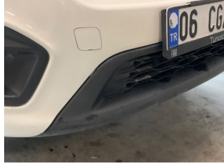
Tampon, ön, Ön tampon ızgarası > Kırılmış
