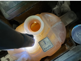
Motorsoğutması, Soğutma sıvısı > Kirlenmiş
