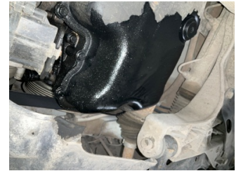
Motor, Motor > Yağ Kaçağı
