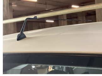
Komünikasyon/Navigasyon/EğlenceKapı, sol ön, Kapı, sol ön > sistemleri, Anten > Hasarlı
