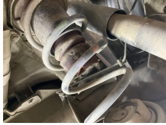
Arka aks, Amortisör körüğü, sağ > Hasarlı
