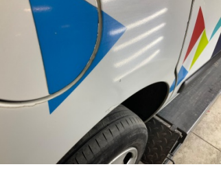
Çamurluk, sağ arka, Çamurluk, sağ arka > Ezik
