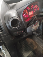
Kalorifer/Klima, Havalandırma ızgarası > Hasarlı
