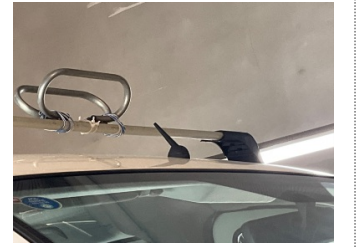
Komünikasyon/Navigasyon/Eğlence sistemleri, Anten > Hasarlı
